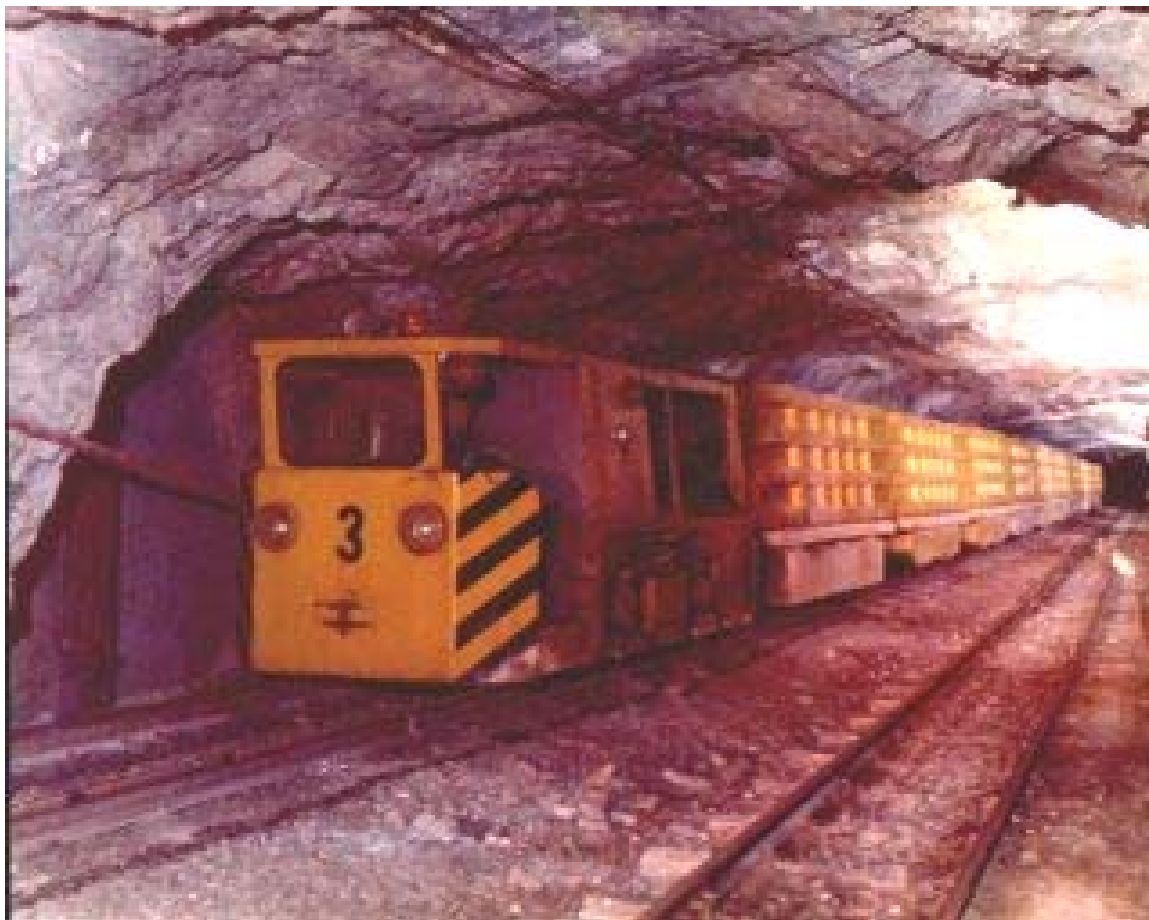
Esempio di galleria di carreggio di grande sezione - Galleria Ornella a Masua-Nebida-Acqua Resi con treno Parkano per il trasporto del minerale, a doppio binario impostata nei calcari cambrici, non armata
