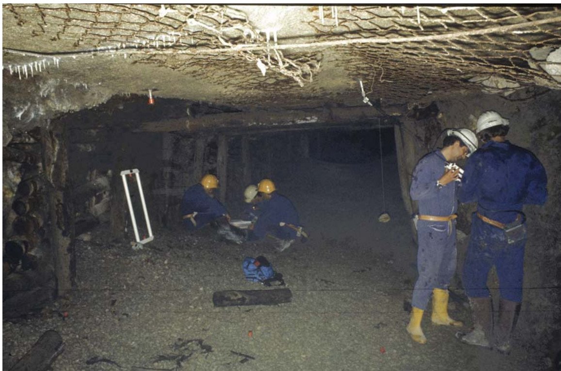
Foto (personale) – 1981 Misurazioni sui cedimenti delle pareti nelle aree di coltivazione a solette cementate (a tetto e a letto)
